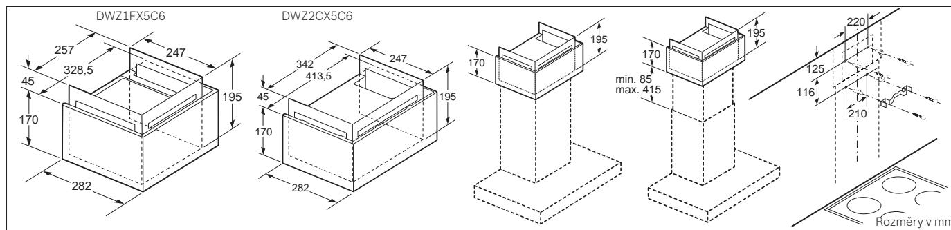
CleanAir Plus montážní sada pro provoz s cirkulací pro nástenné odsavače DWZ1FX5C6 | DWZ2CX5C6
