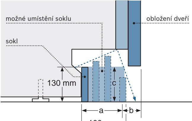
Schéma vpravo: vzdálenost soklu nesmí přesáhnout 60 mm (rozměr **a** - při 130mm výše soklu).
