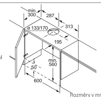
Vestavba variabilního předního ovládacího modulu v úchopné liště není při použití sníženého rámu možná. Ve sníženém rámu je umístěna speciální úchopná lišta, která není vhodná k uchycení ovládacího modulu.
